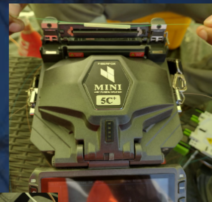
Termocontracción de manguito protector
